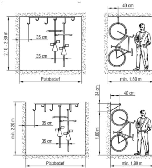
Aufhängungen werden dann eingesetzt, wenn engste Platzverhältnisse wie in Garagen oder Kellerräumen vor-herrschen. Die höhenversetzten und mit Felgenschutz versehenen Haken bieten einer maximalen Anzahl an Fahrrädern sicheren Halt. Die Aufhängungen können problemlos in Eigenmontage an Decken (Typ A) oder an Wände (Typ AK) montiert werden. Befestigungsmaterial wird mitgeliefert.
